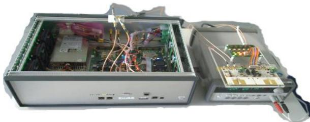
Abbildung 10: Hardware für multi-gigabit Breitband OFDM-Basisbandprozessor
