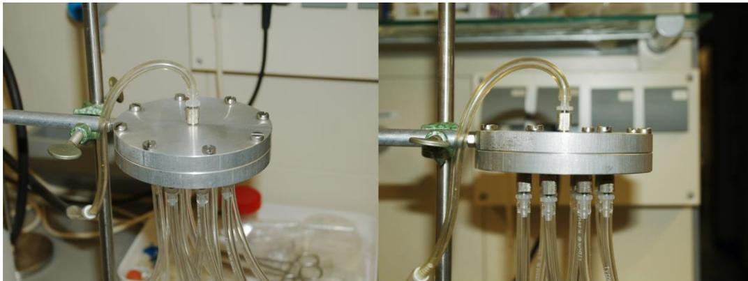
**Abbildung 14:** Weiterentwicklung des Gas-Verteilers mit druckgesicherter Technik zur gleichzeitigen Anaerobisierung von 12 Kulturröhrchen durch Evakuierung mit Hilfe einer Vakuumpumpe und Begasung mit reinem Stickstoff.
