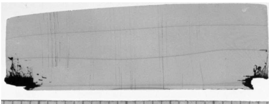
Abb. 15: Längsschnitt durch einen 30 mm Kristall, geläppte Rückseite TaC-beschichtet
