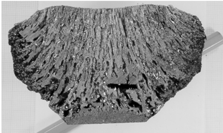
Abb. 9: Längsschnitt durch eine benutzte SiC - Quelle
