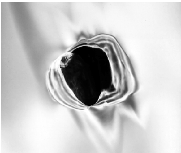
Abb. 36: ca. 1 \mu\text{m} großer Einschuß im SiC - Einkristall (TEM, 30 000 x)
