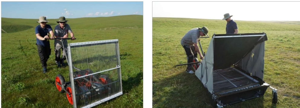
Abbildung 53: Prototyp Nr. 1 im stehenden Einsatz (links) und im liegenden Einsatz mit Fangplane (rechts).
