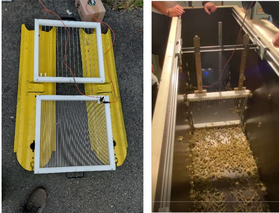
Abbildung 59: Fertige Prototypen mit unterschiedlichen Gitterabständen (links) und Versuchsaufbau unter Laborbedingungen (rechts).
