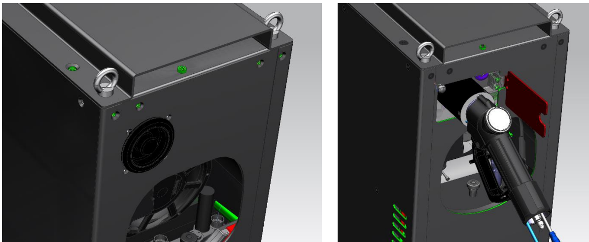
Abbildung 28: links 1. Tankklappenkonzept / rechts KION-Tankklappenkonzept
