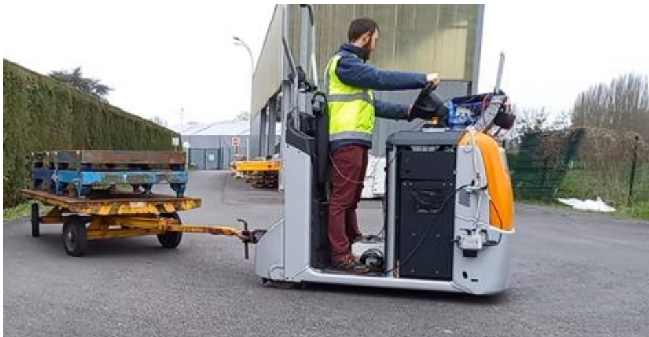
Abbildung 41: performantes Arbeitsspiel Routenzugschlepper in Chatellerault (FR)
