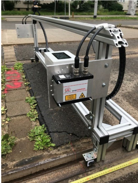
Abbildung 15: Spezifischer Messpunkt zur Erfassung der 2D-Profile (MK 3)
