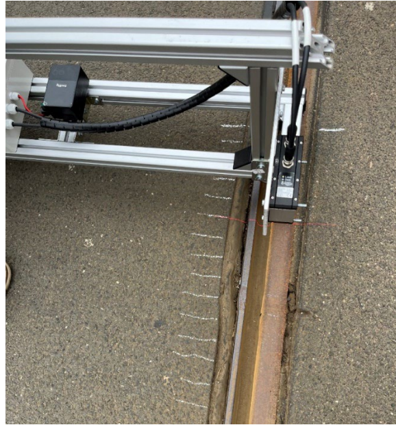
Abbildung 16: 100 cm langes 3D-Profil mit einem 2D-Profilabstand von 5 cm (MK 2 und 3)
