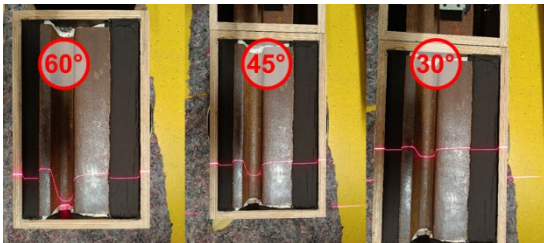
Abbildung 8: Szenario 2: Einstrahlungen des Lasers bei 60°, 45° und 30°
