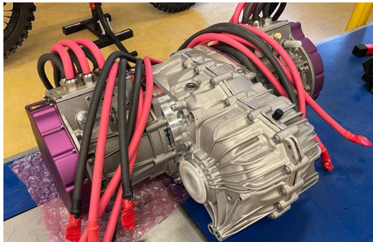
Abb.6: Antriebseinheit des Prototyp V2 – schmalere Flanschplatten
