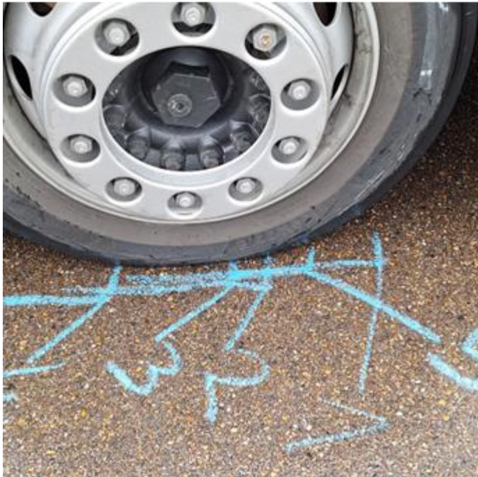
Abbildung 54: Messung Querversatz KAMAG PT bei DACHSER südlich vom Hauptgebäude
