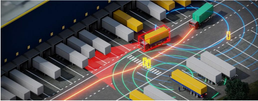
Abbildung 31: Dezentralisierter Einsatz von Infrastrukturknoten zur Erweiterung des Objekterfassungssystems (schematische Darstellung).
