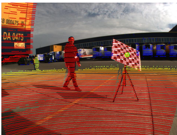
Abbildung 46 Ergebnis der Lidar- / Kamerakalibrierung. Die Lidarpunktwolke wird sehr präzise über das Bild der Kamera gelegt.
