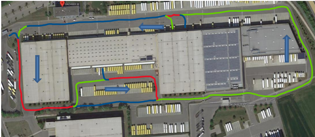
Abbildung 28: Skizze für eine einfache City-Map zur Suche nach dem kürzesten Pfad auf einem Netzwerk der gespeicherten Pfade. Die Suche erfolgt mit der Hilfe des TruckTrix-City Pfadplaners. Alle Pfade haben eine vorgegebene Richtung und können über eine Liste erlaubter Fahrzeuge verfügen.
