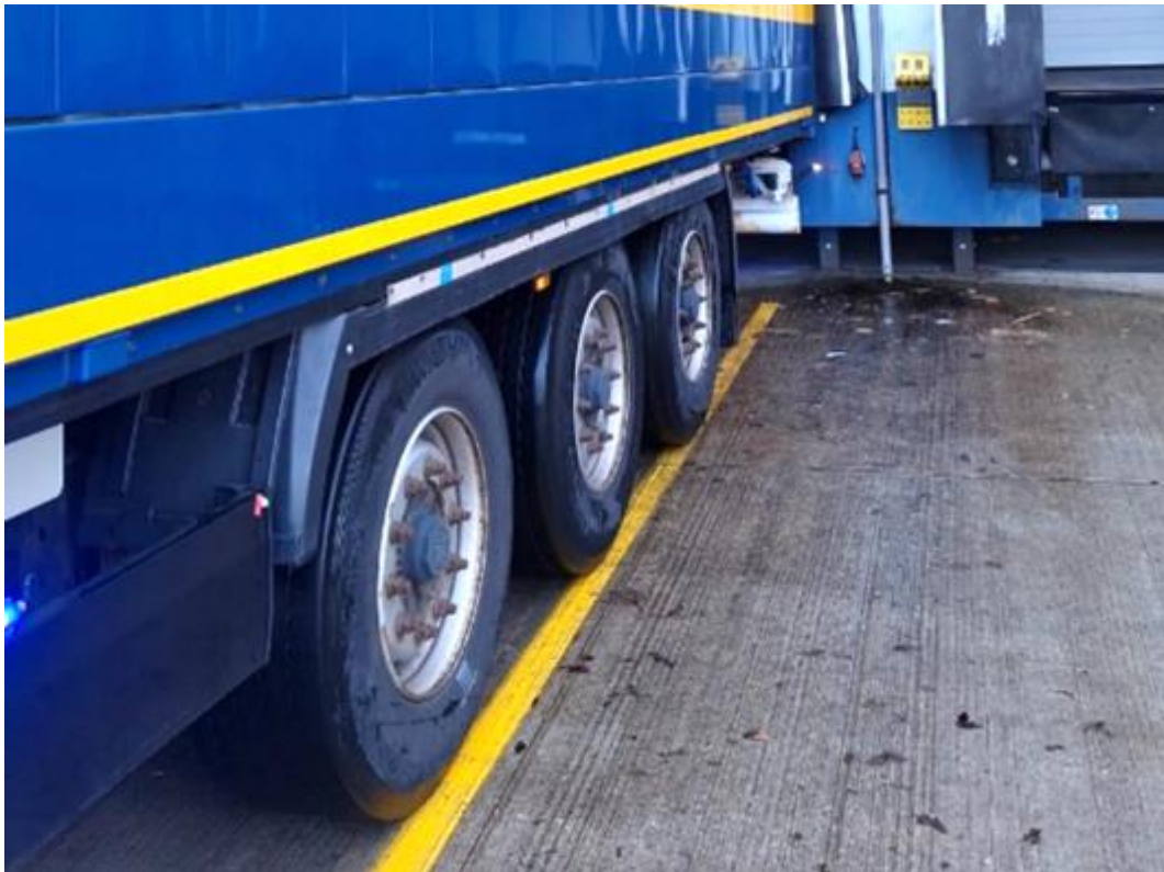
Abbildung 56: Erfolgreicher Endzustand beim Andocken eines Trailers an eine Rampe
