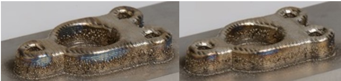
Abbildung 2.5-3: LMD gefertigter Flansch: a) konstante Laserleistung b) mittels KI vorhergesagte Laserleistung
