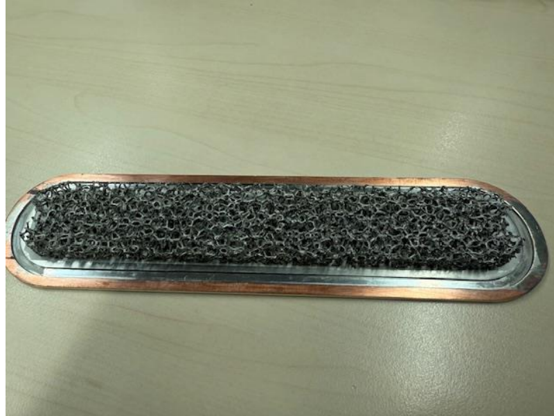
Abbildung 85: Finale Kühlstruktur; Kupferschaum auf Kupfer baseplate galvanisiert und vernickelt
