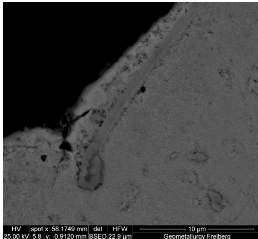
Abbildung 57: Nickelfahne zur Aktivierung der Kunststoffoberflächen
