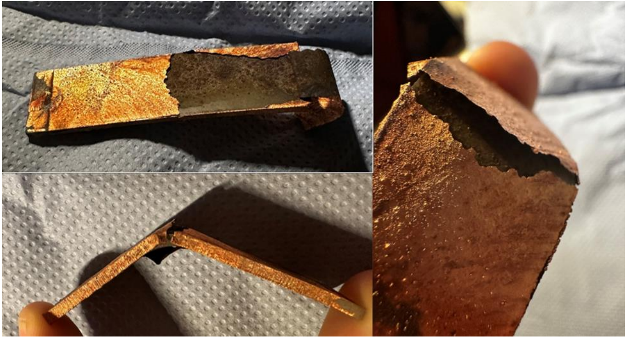
Abbildung 5: Probleme bei der Schichthaftung der Cu-Schicht auf dem PUR-Substrat (Vollmaterial)
