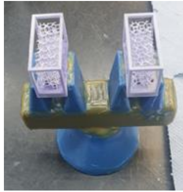
Abbildung 42: Traubenmontage für Mikrofeinguss
