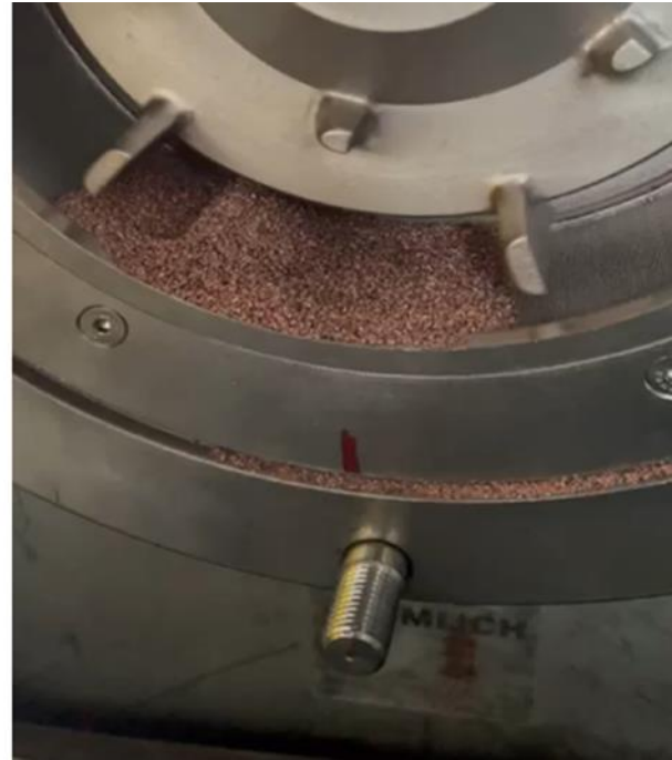
Abbildung 64: Nichtzerkleinertes Material in der Hammermühle bei 20 und 35 m/s (oben) und in der Universalmühle bei 20 m/s (unten)
