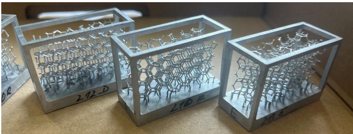
Abbildung 56: Technologiedemonstratoren Feinguss (links) Dreieckssteg, (Mitte) Rundsteg, (rechts) gradierte Stege
