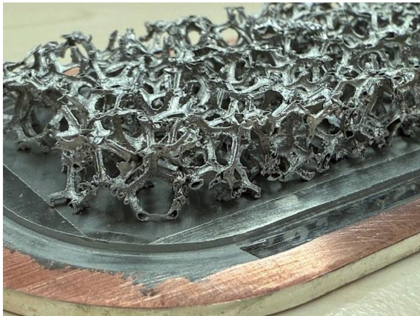
Abbildung 85: Finale Kühlstruktur; Kupferschaum auf Kupfer baseplate galvanisiert und vernickelt
