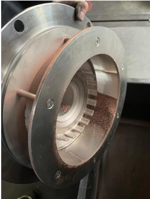
Abbildung 64: Nichtzerkleinertes Material in der Hammermühle bei 20 und 35 m/s (oben) und in der Universalmühle bei 20 m/s (unten)
