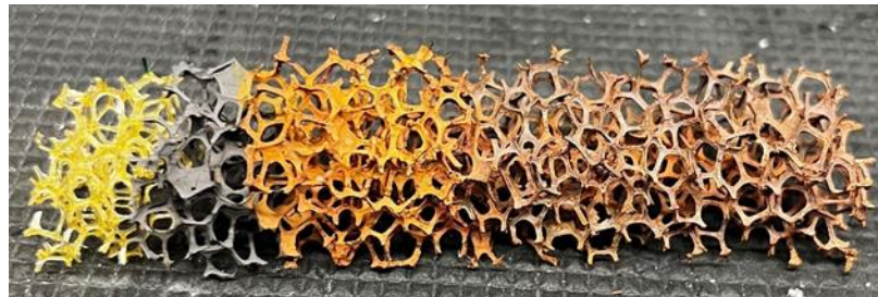
Abbildung 7: Verschiedene Stufen der Galvanisierung von PUR-Schaum (1-Schaum, 2-nanoskaliges Fe, 3-chemisch Cu, 4-galvansich Cu)
