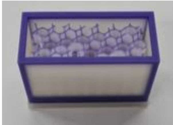
Abbildung 4: Probekörper Abmessung L/T/H (in mm) = 38/20/25 hergestellt im Wachsdruckverfahren.
