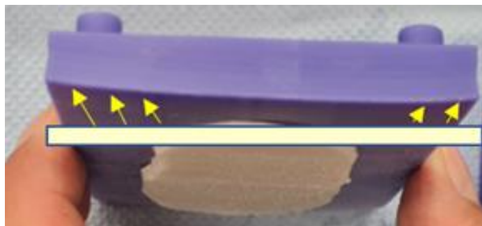
Abbildung 48: Fehlerhafte Bauteile bei horizontaler Bauausrichtung
