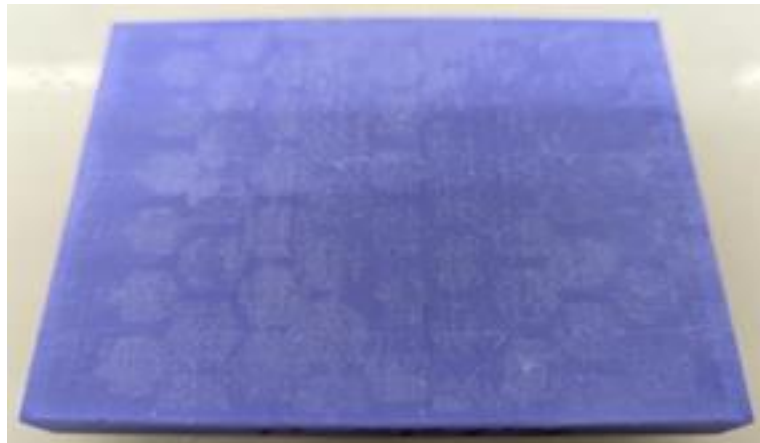
Abbildung 51: Gedrucktes Demonstratorbauteil mit der Draufsicht auf die Unterseite. Die beschriebene Wabenstruktur ist deutlich erkennbar
