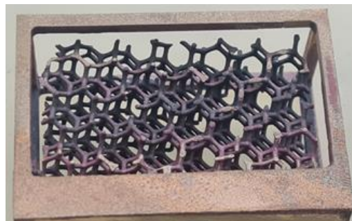
Abbildung 44: Kühlgitter-Modell in CuSn10-C (CC480K) mit runden Stegquerschnitte (Typ R)
