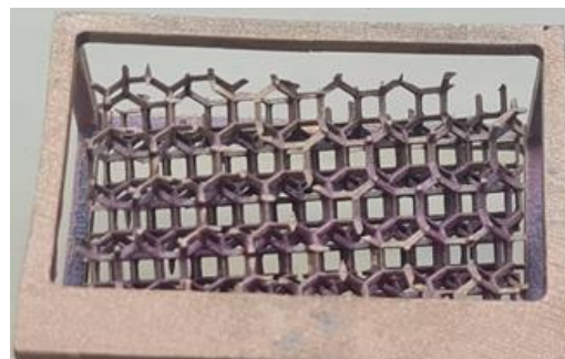
Abbildung 45: Kühlgitter-Modell in CuSn10-C (CC480K) mit runden Stegquerschnitte (Typ D)
