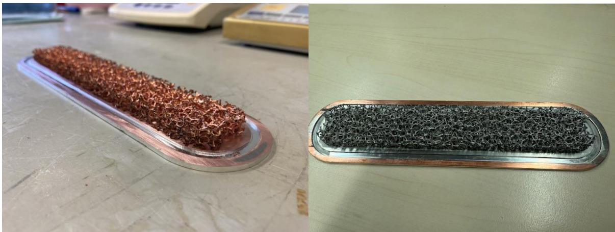
Abbildung 113: Schaumstruktur auf Valeo Baseplate; links nicht beschichtet; rechts vernickelt
