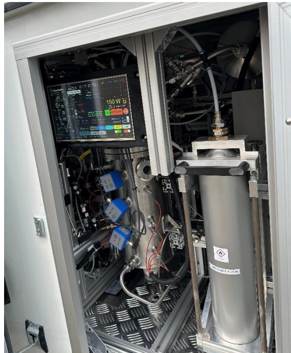
Abbildung 2: Wasserstoffgenerator-Subsystem im Leichtfahrzeug mit POWERPASTE-Kartusche
