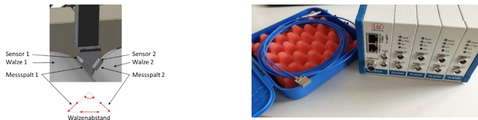
Abbildung 14: Schematische Darstellung des Aufbaus zur kapazitiven Spaltmessung (links) und Foto der beschafften kapazitiven Sensoren vor dem Einbau
