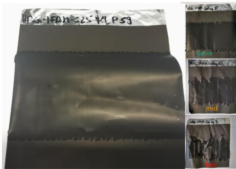
Abbildung 10: Beispiele von am IWS erzeugten Beschichtungen. Die Proben haben alle die gleiche Größe (Beschichtungsbereich ca. 8 cm x 16 cm). Links: Beispiel einer guten Beschichtung mit zur Skalierung geeigneten Eigenschaften. Rechts: Beispiele für die Klassifizierung in gut/mittel/schlecht von Beschichtungsergebnissen nach dem resultierenden Beschichtungsbild.
