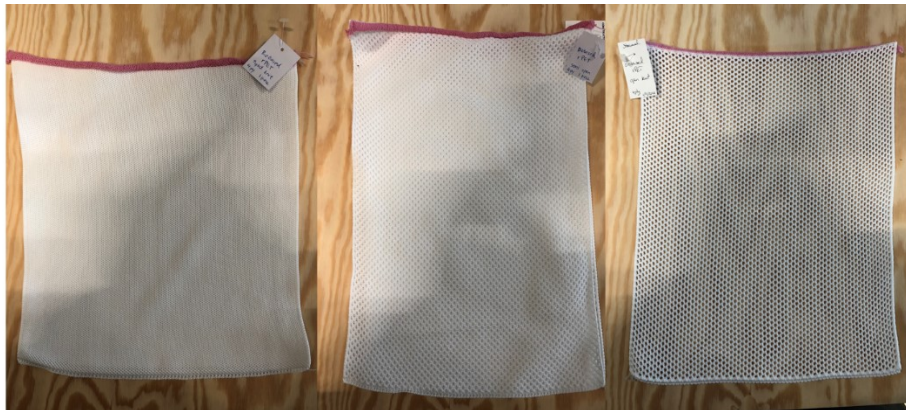
Abbildung 2. Drei Strickstrukturen aus Benchmark 1. Enge Strickstruktur (links), halboffene Strickstruktur (Mitte) und offene Strickstruktur (rechts).
