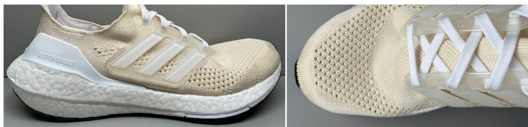
Abbildung 9. Flex-Test Aufbau (oben) und Demonstrator-Schuhe nach 50.000 Flex-Test-Zyklen (unten links und rechts). Es wurden keine Brüche oder Schäden festgestellt.
