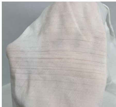
Abbildung 3. Defekte im Gewebe aus Benchmark 2
