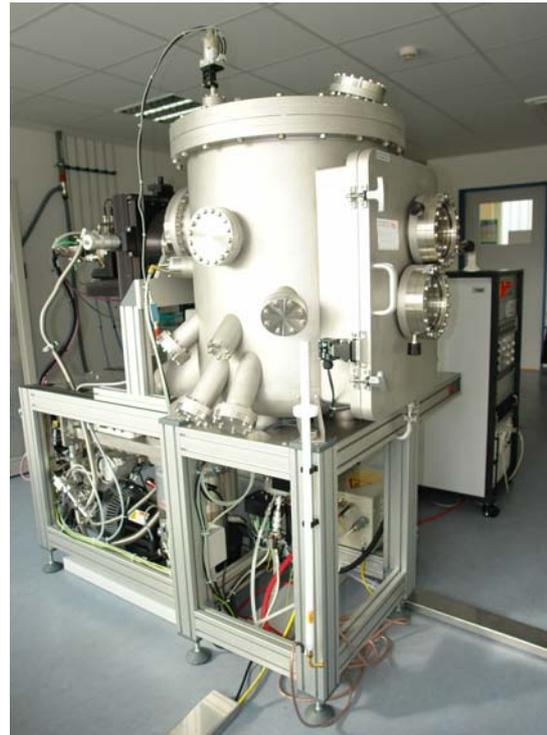
*Abbildung 1: GLAD-Anlage mit Elektronenstrahlverdampfung im Leibniz-Institut für Oberflächenmodifizierung in Leipzig*
