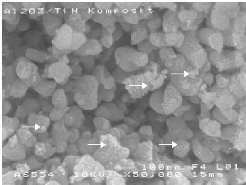
**Bild 15:** Bruchfläche eines  $\text{Al}_2\text{O}_3/\text{n-TiN}$  Grünkörpers der über elektrostatische Beschichtung hergestellt wurde. Auf den  $\text{Al}_2\text{O}_3$ -Matrixkörnern konnten 30-100 nm große TiN-Partikel detektiert werden. Hinweispeile zeigen einige der TiN-Partikel.
