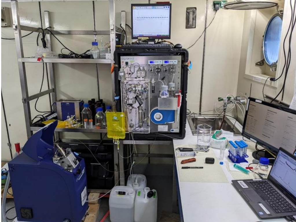
Abbildung 7 Das Xplotector-System auf dem Labortisch im ALKOR-Nasslabor während der Fahrt AL603. Das CMS-Massenspektrometer ist das blaue Instrument unten links im Bild.
