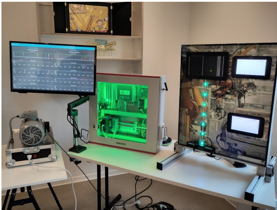
Abbildung 27: Foto der beiden Tischdemonstratoren. Links ist der QoS Demonstrator mit Sensor, Motor, Anzeige und Schaltschrank zu sehen, rechts der Migrationsdemonstrator mit Sensor und Edge Gerät sowie Monitoren zur Darstellung der jeweiligen Workloads.
