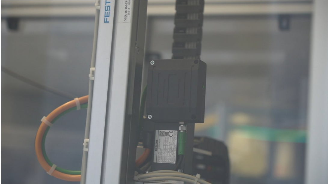
Abbildung 4: SSI Multisensor auf dem 3-Achsen-Positionierungs-Präzisionsroboter montiert mit aktiver Verbindung zum Industrial Edge Gerät.
