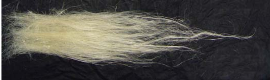
Bild 20: endengeordnete Faserbündel aus dem Faseraufschluss
