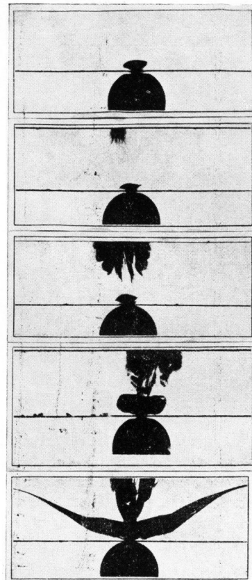
Bild 9. Fünf verschiedene Phasen vom Bruchbeginn.
