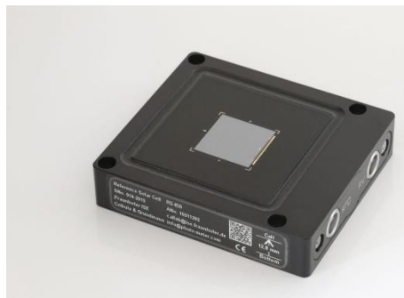
Abbildung 6: WPVS-Solarzelle mit primärreferenziertem Kurzschlussstrom zum Standardbeleuchtungsspektrum AM1.5G. Die Referenzstromsolarzelle hat einen Temperatursensor verbaut, welcher ebenfalls ausgelesen und geloggt wird.
