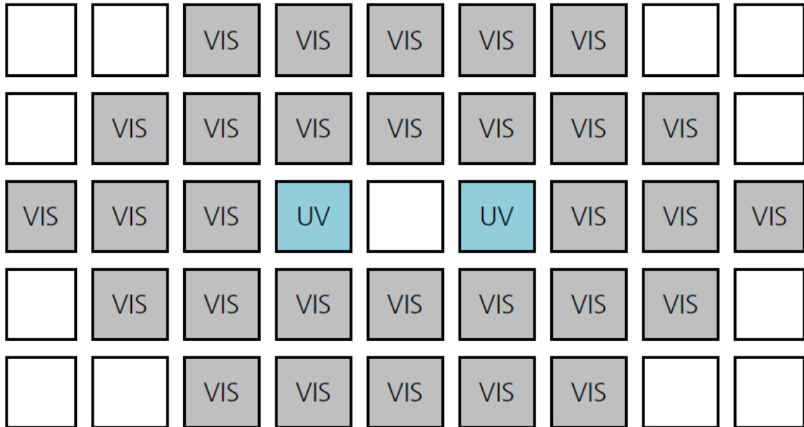
Abbildung 2: Verteilung der LED-Boxen im Schirm der Beleuchtungseinheit. Die Optiken sind so ausgelegt, dass sich in der Messebene das LED-Licht perfekt mischt und homogenisiert. Alle Boxen beleuchten das vollständige Messfeld.
