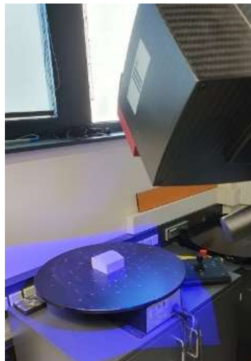
Abbildung 14: Optische Vermessung mit GOM ATOS. Die Testgeometrie wurde vorher mit Kreidespray eingesprüht, um die Reflexion bei der Vermessung zu minimieren
