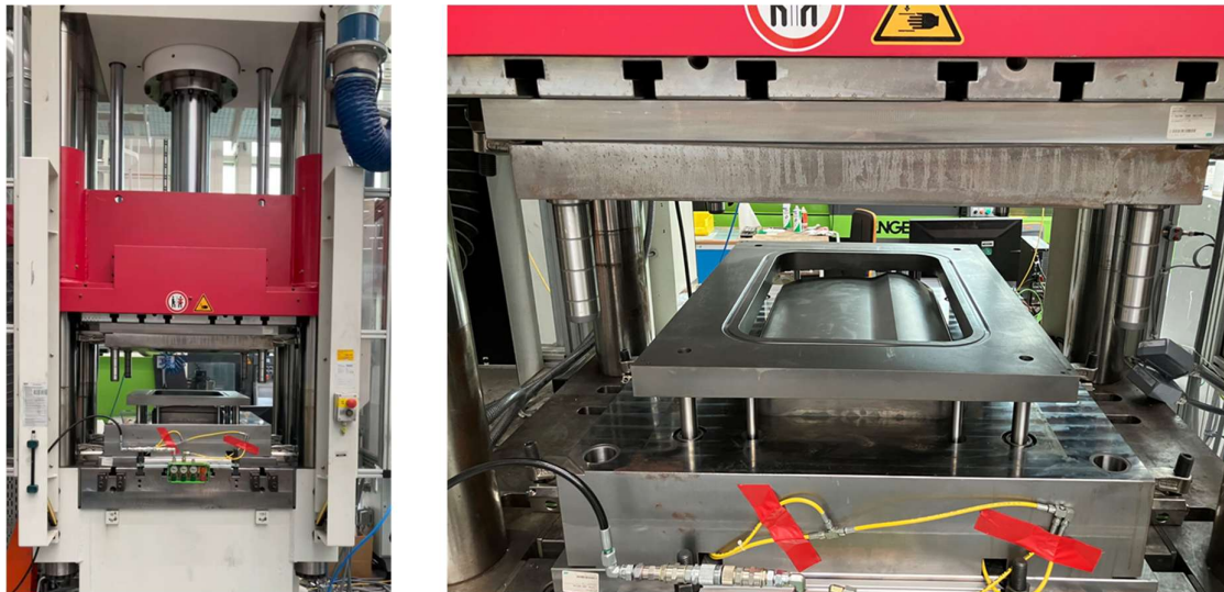
Abbildung 7: Eingebautes Werkzeug in der Presse (Fa. Röcher, 160 t Hydraulikpresse)
