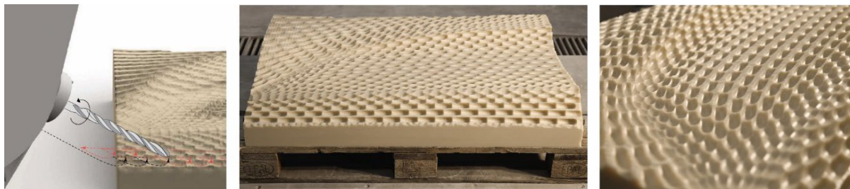
Abb. 10; links: Frässtrategie Akzentuierung vergleichbar der Oberflächenbearbeitung mit einem Bohrmeißel, Mitte: gefräster Wachsblock, rechts: Detailaufnahme Wachsschalungsoberfläche
