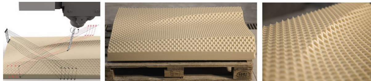
Abb. 8; links: Frässtrategie gekreuzte Rasterakzentuierung, Mitte: gefräster Wachsblock, rechts: Detailaufnahme Wachsschalungsoberfläche
