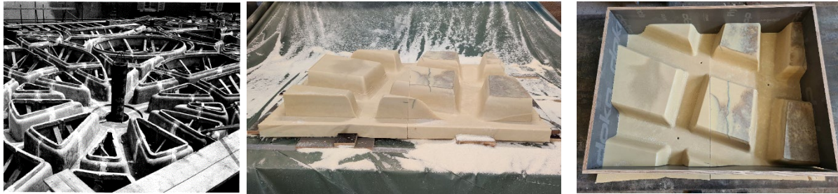
Abb. 12; links: Vorbild Pier Luigi Nervi [6], mitte: bei BNB gefräste Wachsblöcke, rechts: fertige Hybridschalung
