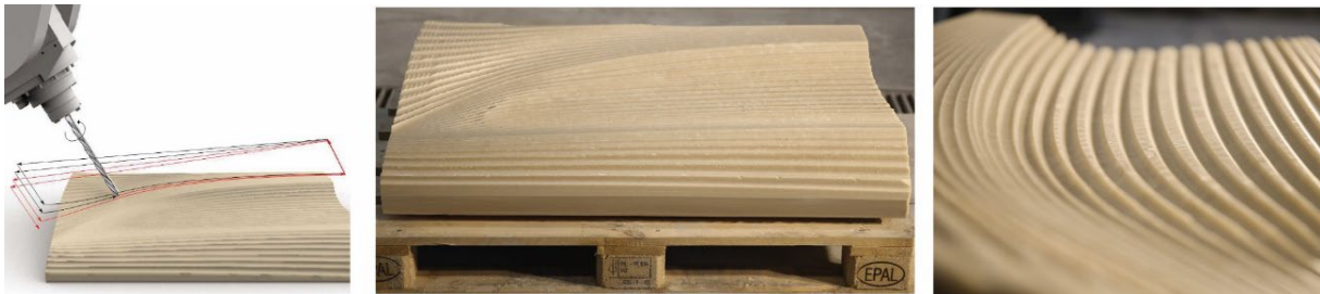
Abb. 9; links: Frässtrategie Topologie angepasste Rasterakzentuierung, Mitte: gefräster Wachsblock, rechts: Detailaufnahme Wachsschalungsoberfläche
