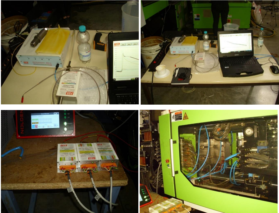
Abbildung 6. FOS-Messausrüstung beim Einsatz während der Messkampagnen bei Exipnos. Das im Projekt entwickelte DAQ-Gerät ist rechts oben auf dem Tisch zu erkennen, auf dem Laptop sieht man die Mess-Datenaufzeichnung durch die spezielle LabView-Software. Unten ist die Variante mit drei Sensoren im Einsatz gezeigt.
