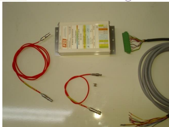
Abbildung 3. (oben) Schematische Darstellung eines MTPS-IR Kombisensors von FOS mit seinen Komponenten und (unten links) Bild des im Projekt InKriS für die Signalerfassung in der Spritzgussform verwendeten MTPS-IR Kombisensors MTPS-IR Sensors sowie (unten rechts) der Messkette mit den eingesetzten Hardwarekomponenten (Sensor, Verbindungskabel und Messverstärker).
