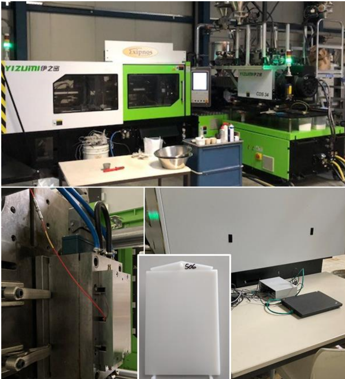
Abbildung 13. Integration einer ersten Testversion des Kristallisationssensors mit der zugehörigen Erfassung- und Auswerteelektronik an der Spritzgussmaschine. Oben: Spritzgussmaschine mit DCIM-Modul, unten links: Feste Seite der eingebauten Spritzgussform mit IR-Sensor, unten rechts: Datenerfassungs- und Auswerteelektronik zum Kristallisationssensor. Das Notebook dient hier der Überwachung der Datenerfassung und -auswertung während der Testphase, unten Mitte: hergestelltes SG-Bauteil aus PP.
