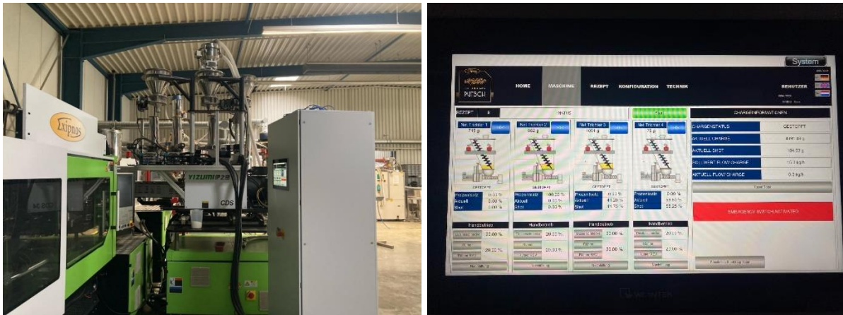
Abbildung 30. (links) Dosiersteuerung (rot umrandet) für die vier Dosiereinrichtungen (blauumrandet) an der Spritzgussanlage mit DCIM bei Exipnos und (rechts) Blick auf den Bildschirm der Dosiersteuerung während einer Kampagne.
