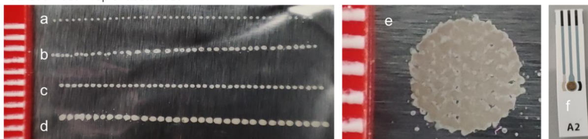
Abb. 22: RegenHu Druckkopf CF-300h mit Microvalve CF300 (ID=0.15 mm) und BTV-Siebdruckelektroden mit Funktionalisierung (drei Schichten) sowie die entsprechende Kontrolle.
