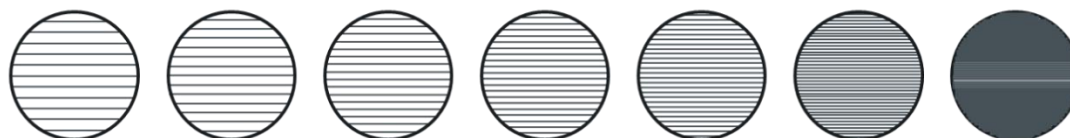
Abb. 23: Anpassung des Druckmusters mittels Variation des Tropfenabstandes und des Linienabstandes (a: 0,5, b: 0,3, c: 0,2, d: 0,1 mm). Das beste Ergebnis (e: auf Aluminiumfolie, f: auf Carbon-Arbeits-elektrode einer Siebdruckelektrode) wurde für einen Tropfenabstand von 0,5 mm und einer Kombination unterschiedlicher Linienabstände erreicht. Es wurden insgesamt 14 Kreise übereinander gedruckt die mit Linien in unterschiedlichen Abständen gefüllt waren (zweimal 0,35 cm+ 0,3 cm+ 0,25 cm + 0,2 cm + 0,15 cm+ 0,1 cm+ 0,05 cm Linienabstand).
