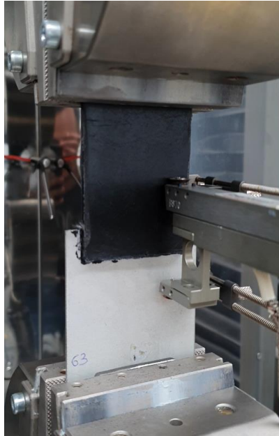
Figure 35: Scherzug Versuch im Ibertest
