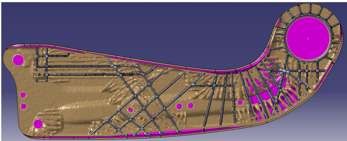
Figure 44: Topologie Optimierungsergebnis in CAD Konstruktion umgesetzt
