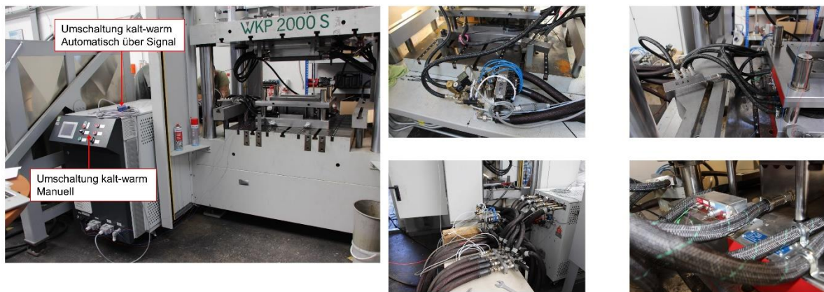
Figure 14: Anschluss von Ventilstationen mit Werkzeug
