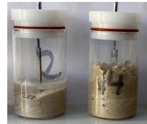
Abb. 6: li. Ref.-Bindemittel, re. RC-SG-M mit gequollenen Bestandteilen
