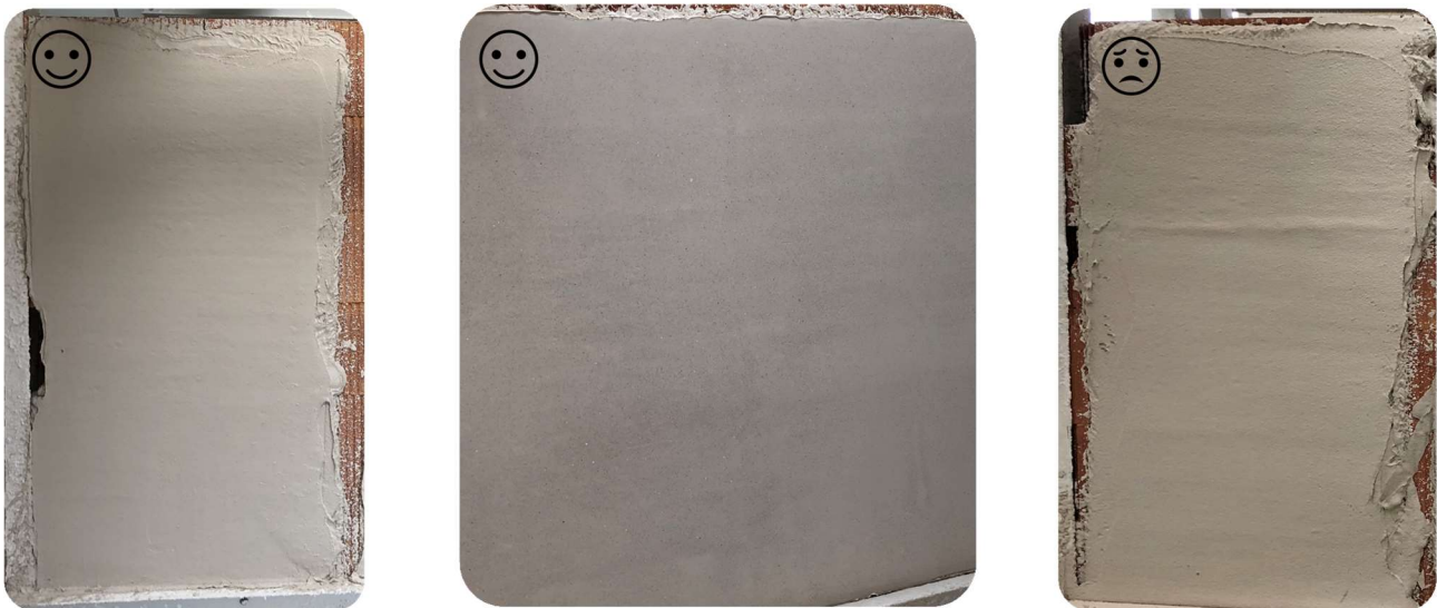
Abb. 22: Beispiele von Testflächen zur Optimierung der Additivkombination am Beispiel einer Putzgipsmischung mit 32 % RC-SG ind. , links: ohne Additivanpassung im Vergleich zur Referenz auf Naturgipsbasis, Mitte: verringerter Anteil an MC und Verzögerer, rechts: zu geringer Anteil an MC
