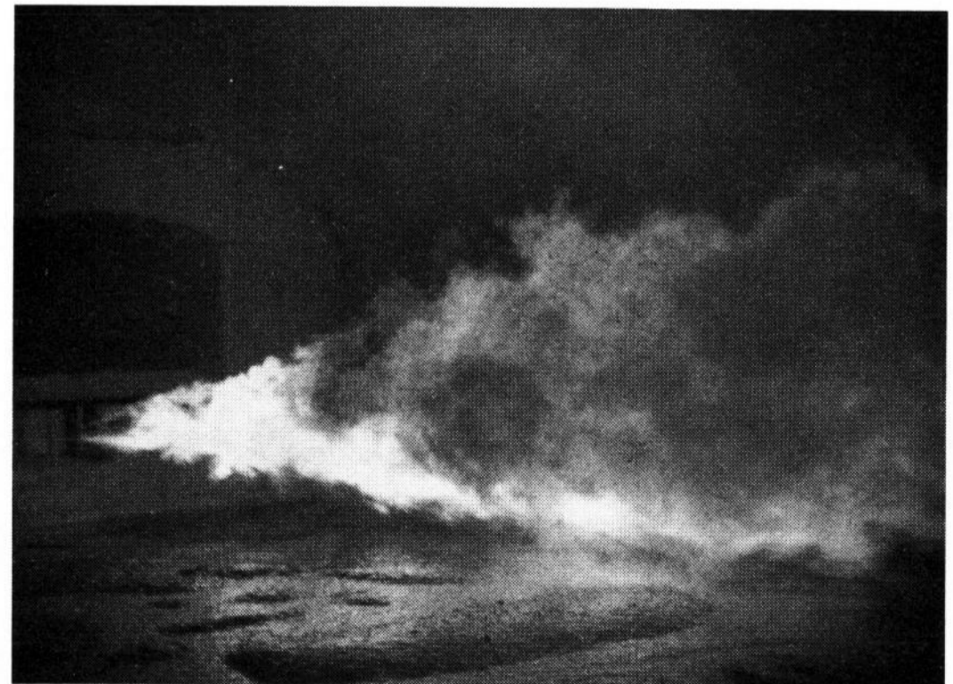
Bild 8. Überschichtung der Sauerstoffflamme durch die Flammen des Außenzerstäubers, 1/1000 s.
