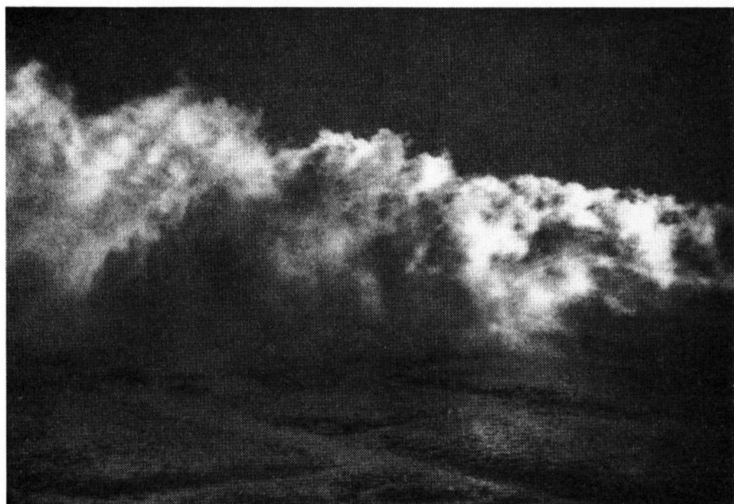
Bild 7. Flammenausbildung am rechten Brenner ohne Sauerstoffzusatz, 1/1000 s.
