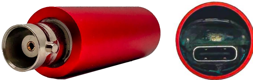
Abbildung 28 - Verbesserte Version des OmnAIScope mit ausgerichtetem BNC in rot eloxiertem Aluminiumgehäuse
