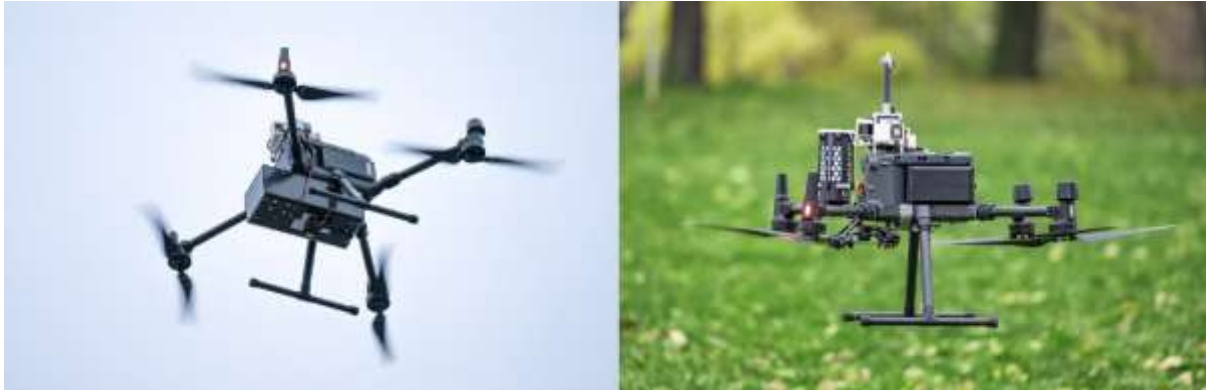
Abbildung 3 Die verwendeten Messsysteme. Links das Messsystem mit sensiblen NO 2 Sensor. Rechts das Messsystem ohne sensiblen NO 2 Sensor, aber mit Fallschirm.
