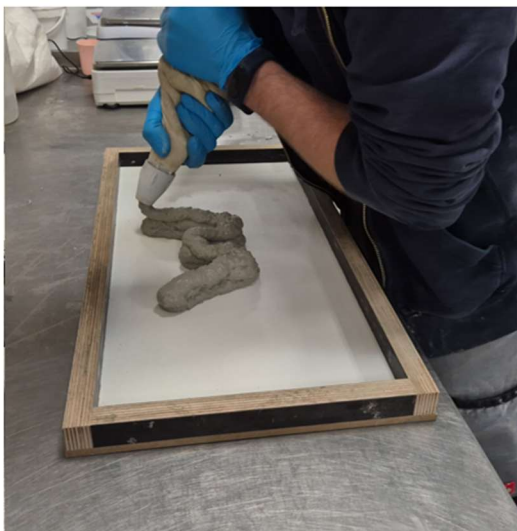
Abb. 12: Materialentwicklung Wälzschlackenmischung zur Anwendung der additiven Fertigung von Schachtringen
