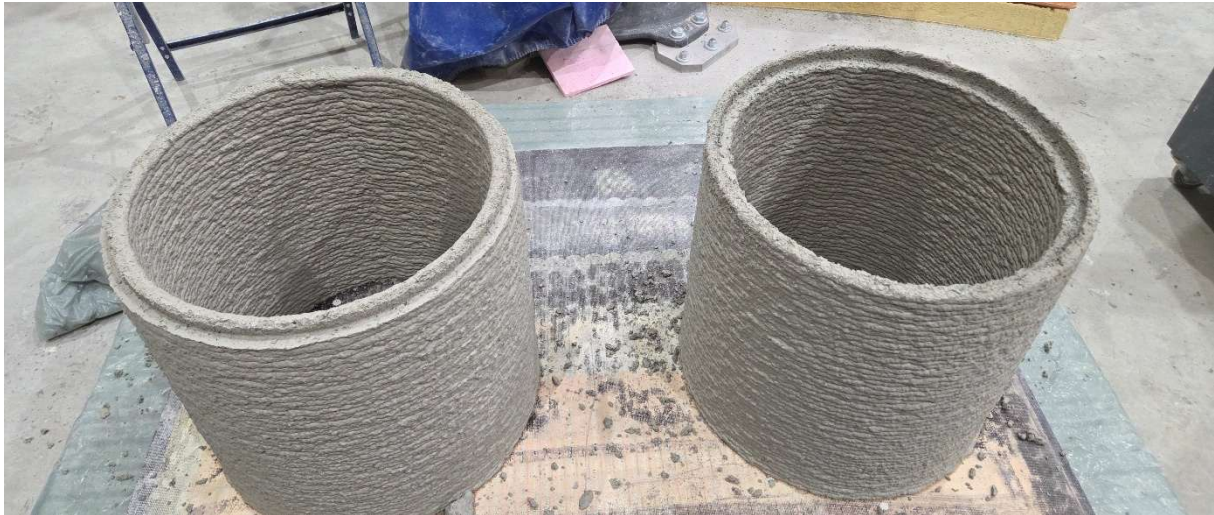
Abb. 13: Additiv gefertigte Schachtringe mit Wälzschlackenmischung im erstarrten und gefrästen Zustand
