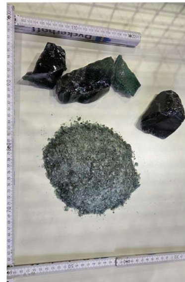
Abb. 10: Aufgabegut (linkes Bild), zerkleinerte Probe (mittiges Bild) und zerkleinerte Probe im Vergleich zum Aufgabegut (rechtes Bild)
