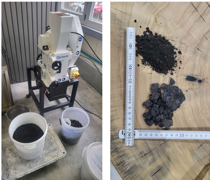
Abb. 5: Zerkleinerung der Wälzschlacke im Backenbrecher (anschließende Feinstmahlung erfolgte einer Planetenkugelmühle)
