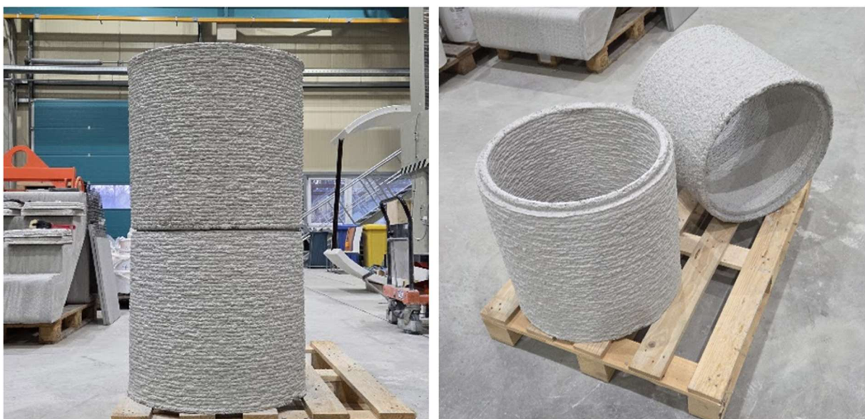
Abb. 14: Additiv gefertigte Schachtringe im ausgehärteten Zustand
