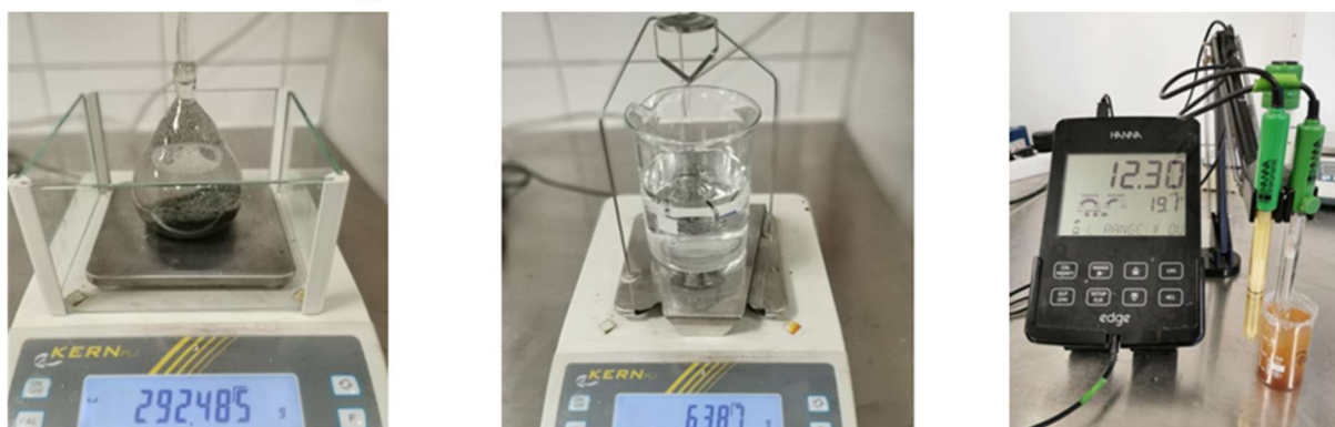
Abb. 2: Bestimmung der Rohdichte (linkes und mittleres Bild) sowie Eluatanalyse (rechtes Bild) Basierend auf den ermittelten Materialwerten (Tab. 1) kann Wälzschlacken in die Kategorie Stahlwerksschlacke der Klasse 2 (SWS-2) der Ersatzbaustoffverordnung eingeordnet werden.
