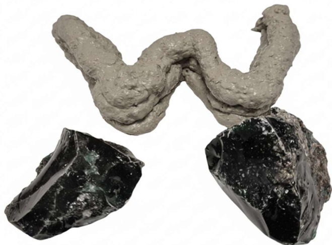
Abb. 12: Materialentwicklung Wälzschlackenmischung zur Anwendung der additiven Fertigung von Schachtringen
