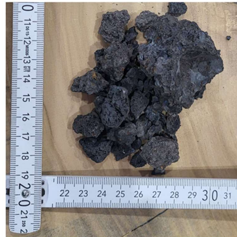
Abb. 9: Wälzschlacke aus dem letzten Projektjahr (linkes Bild) und Wälzschlacke aus dem zweitem Projektjahr (rechtes Bild)
