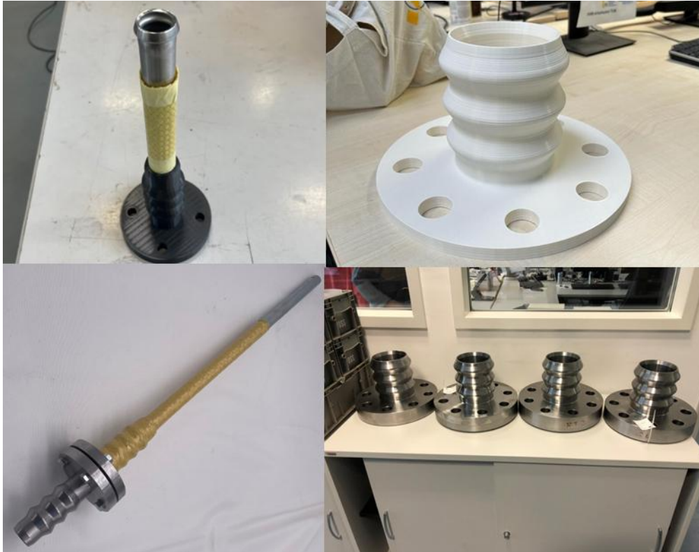
Abbildung 5: Darstellung von Versuchen zur Entwicklung von Verbindungselementen für eine H 2 -Dichtigkeit (Links: Prototyp basierend auf der VossLok40-Technologie, Rechts: Hochskalierung mittels 3D-Prototyp-Druckelement)
