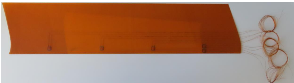
Abbildung 3.15: Gefertigtes Sensornetzwerk vor der Verklebung auf der Vorflügelinnenseite
