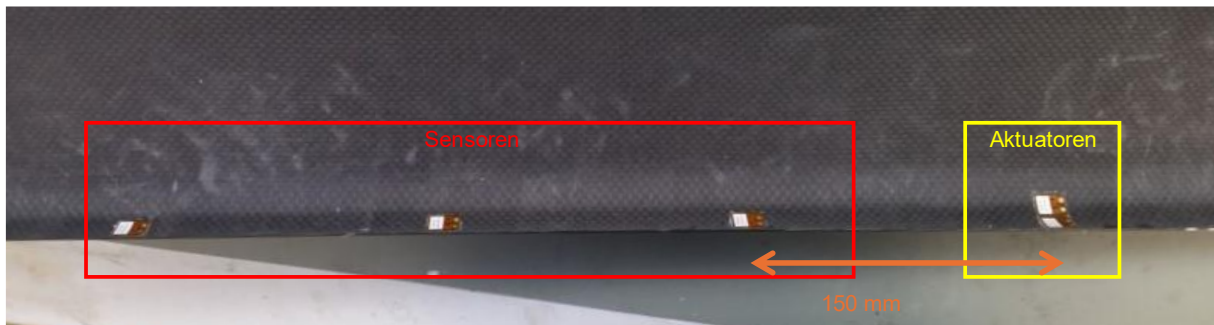
Abbildung 3.10: Auf dem Vorflügel applizierte piezokeramischen Flächenaktuatoren für Vorversuche.
