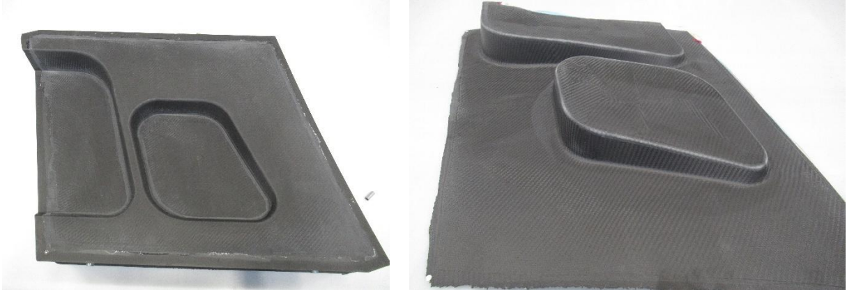
Abbildung 6.42: Links: Bauteilzugewandter Oberfläche des PC-C-Werkzeugs nach dem Ablageversuch. Rechts: Mit dem PC-C-Werkzeug gefertigter Probekörper.
