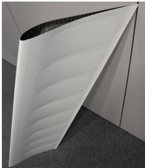
Abbildung 3.5: Für die Vorversuche zur Positionierung der Piezowandler verwendetes Vorabsegment. Hinweis: Das Vorabsegment wurde im Projekt EnerWing (FKZ: 0324355D) gefertigt.
