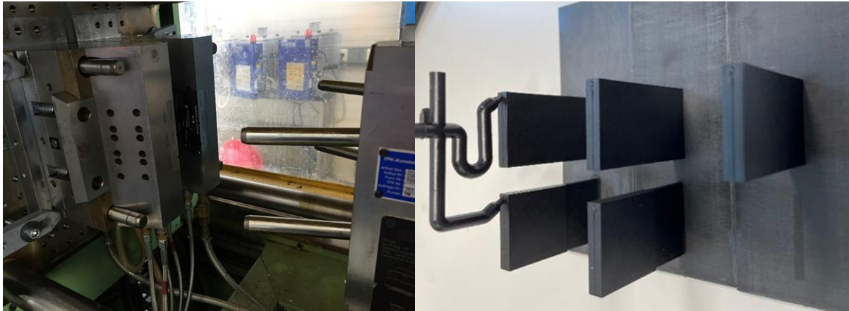
Abbildung 2.12: Platte-Rippen-Spritzgusswerkzeug (links) und generierte Probekörper mit 3 mm und 6 mm Rippenstärke (rechts)
