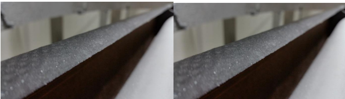
Abbildung 3.17: Eisauflage auf dem Vorflügel bei -10\text{ }^{\circ}\text{C}
