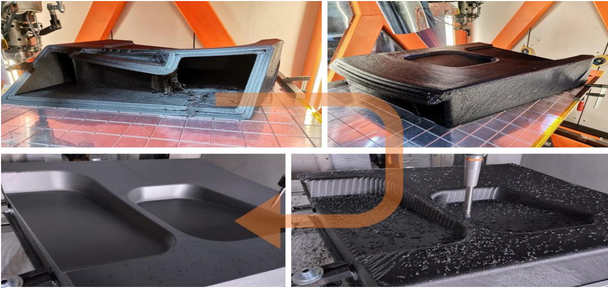
Abbildung 6.38: Additive Fertigung des Formwerkzeuges mit Oberflächennachbearbeitung.
