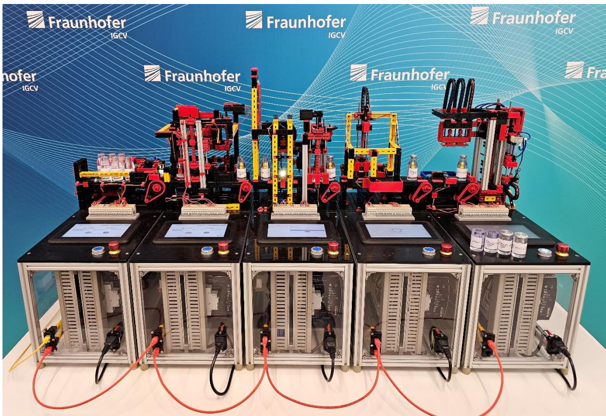
Abbildung 3: Aufbau der Fischertechnik-Demonstratoren
