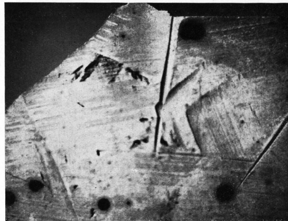
Bild 2a. 4 Schlackeneinschlüsse in der Brennhaut. Bild 2b. Schwarze Schlackenhöfe in gebranntem Ton.
