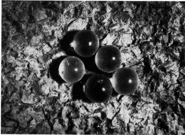
Bild 4. Glaskügelchen auf feuerfestem Material (Bruch).
