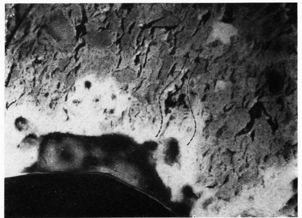
Bild 15. Kapillarer Einbruch der Diffusionszone.
