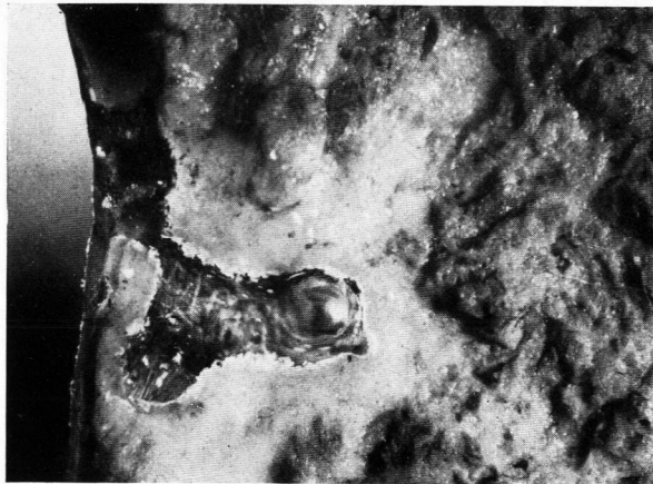
Bild 16. Verstärkter Hohlraum an der Grenzfläche.
