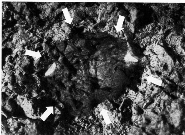
Bild 5. Glas-,pfütze“ auf feuerfestem Material (Bruch).
