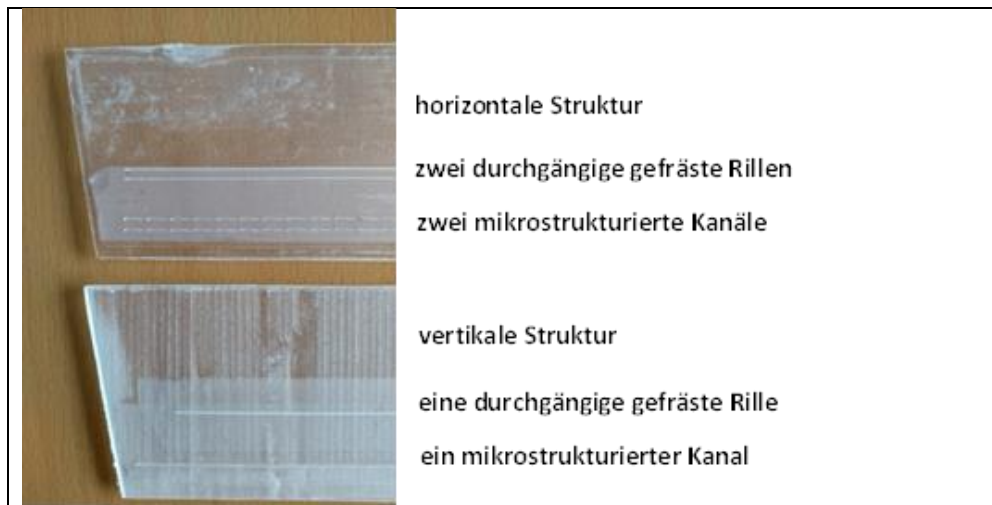
Abbildung 3-16: die linke Seite der mikrostrukturierten Platten
