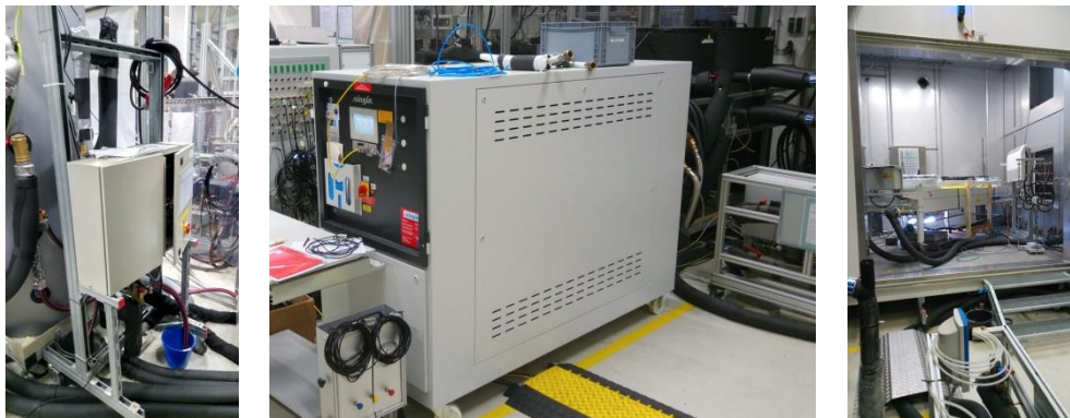
Abbildung 1-25: Wärmequellen – Booster für elektrische Zusatzheizung (links); Sole-Modul zur Abbildung der Erdwärmesonde (Mitte); Luft/Sole-Wärmeübertrager in linker Kammer der Klimakammer (rechts)
