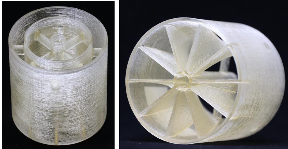
Abbildung 3-43: Testdruck Koax aus AR M2 (stehend gedruckt – horizontale Schichten im linken Bild)
