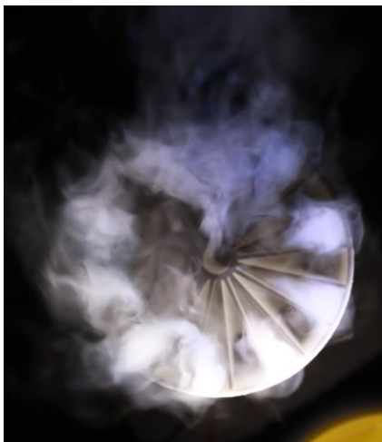
Abbildung 3-47: Durchströmungsversuch mit Rauch
