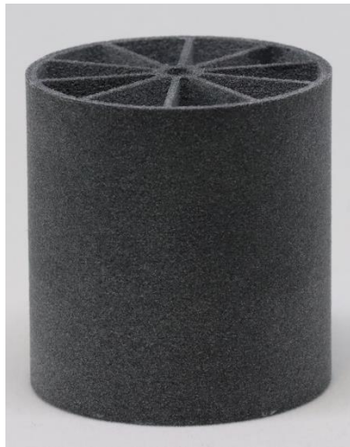
Abbildung 3-41: Testdruck Koax aus PA 12
