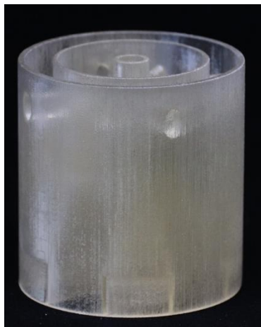
Abbildung 3-42: Testdruck Koax aus AR M2 (liegend gedruckt – vertikale Schichten im linken Bild)
