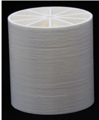
Abbildung 3-40: Testdruck Koax aus ABS
