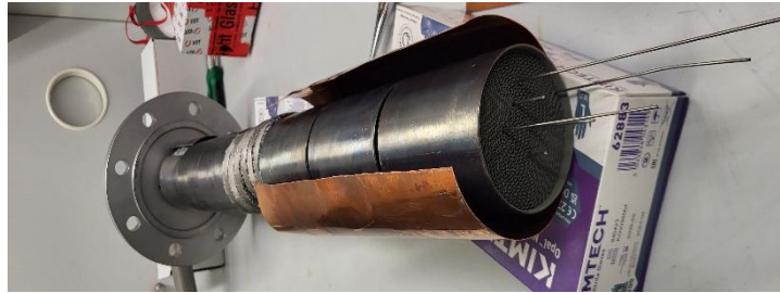
Abbildung 16: Detailfoto des Aufbaus mit zwei Waben und zwischengeschalteter Mischpackung, Temperaturmesslanzen und Weichmetallblechhülle zur Gewährleistung eines hohen Wärmeaustauschs mit dem äußeren Reaktorrohr (hier nicht gezeigt).
