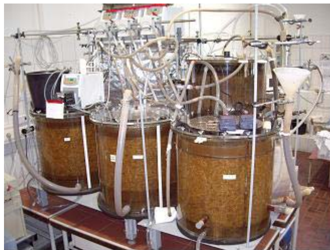
Abb. 12: Aufbau der kleintechnischen Versuchsanlage zum Bioleaching Verfahren mit drei Trockenfermentern (vordere Reihe) und einem Anaerobfilter (erhöht)
