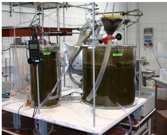
Abb. 2: kleintechnische Versuchsanlage zum Einstau-Verfahren mit flüssigem Gärrest
