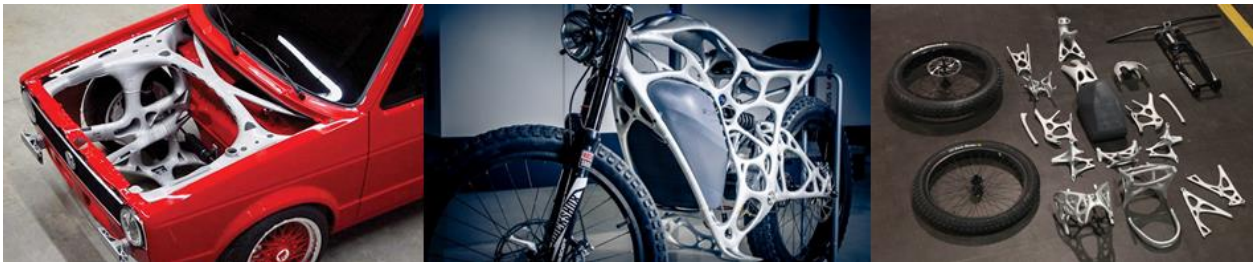
Abbildung 1: Konzeptstudien EOS 3i-PRINT und Light Rider von APWorks bestehen aus geschweißten LPBF-Bauteilen [1, 2]
