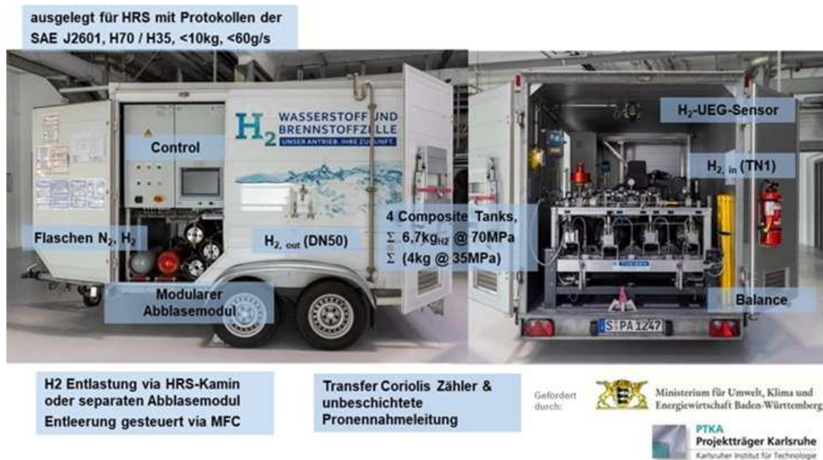
Abbildung 7: Abnahmegerät Fuelling Station Test Module (FSTM) des ZSW
