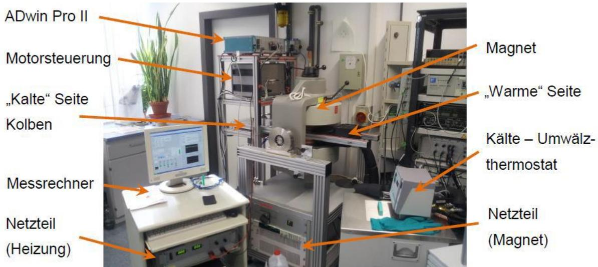
Abbildung 12: Gesamtaufbau des Thermischen Teststandes mit dem Elektromagneten
