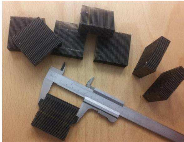
*Abbildung 21: Gadoliniumplatten zu Regeneratoren verbunden. Probengröße 50x50x15mm<sup>3</sup>*
