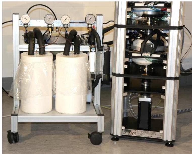
Abbildung 22: links Fluidmanagement-Einheit, rechts angeschlossene MCE-Einheiten mit zwei aktiven Modulen
