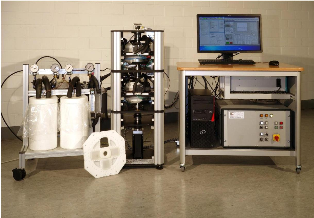
Abbildung 23: v.l.n.r.: Pumpeneinheit mit Wärmetauschern, MCE-Einheit mit zwei Modulen sowie Motormodul, Arbeitstisch mit Steuerbox und Messdatenverarbeitung
