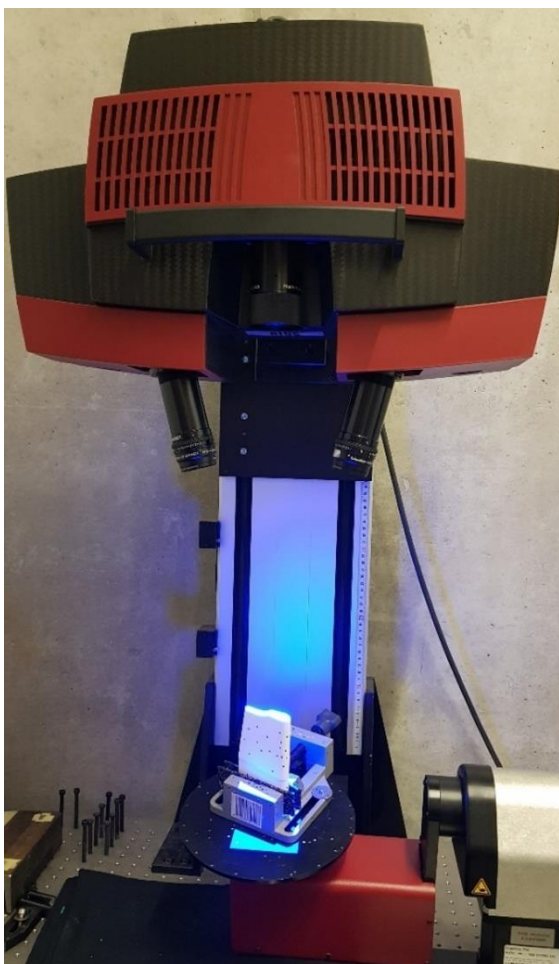
Abbildung 8: Links: Die Probe ist auf einem drehbaren Tisch fixiert, der 3D-Scanner befinden sich oberhalb. Rechts: Die Probe wird gescannt.
