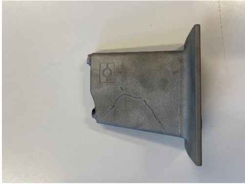
Gussteil 1 nach dem Strahlen (Kern vor dem Prozess getrocknet bei 110 °C)
