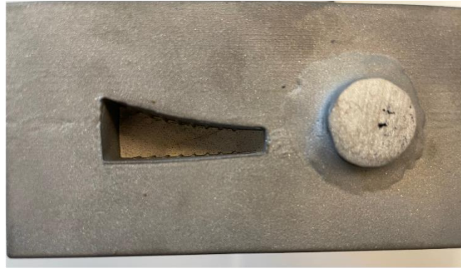
Gussteil 1 nach dem Strahlen (Kern vor dem Prozess getrocknet bei 110 °C)
