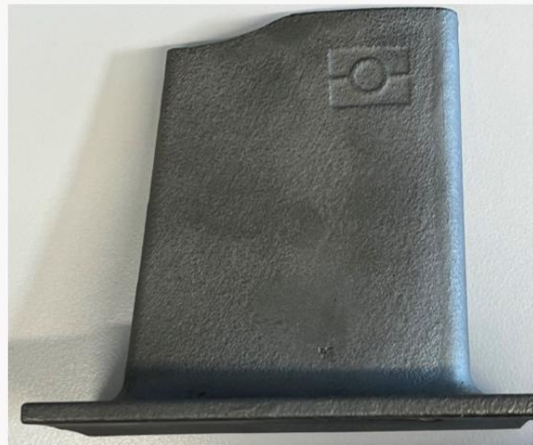
Abbildung 24: Gießtechnische Betrachtung der Kerne im Schalenfeinguss (Nickelbasislegierung 2.4671)
