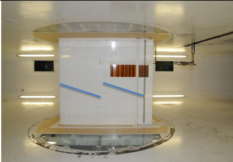
Abbildung 40 Windkanalmodell eingebaut im Windkanal. Druckseite mit Hot-Film Sensoren (orange) und Druckbohrungen (blau)
