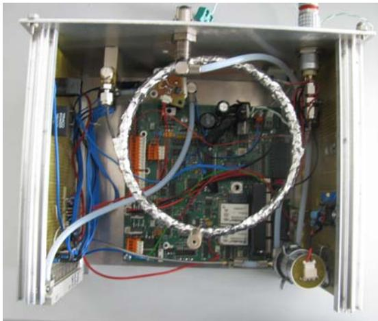
**Abb. 31:** Innenansicht des neuen Sensormoduls mit GC Kapillare.
