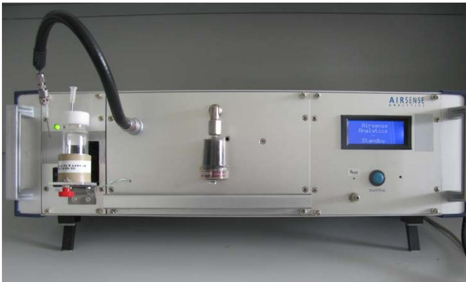
**Abb. 32:** Foto des neuesten Prototypen der „BiogasNase“. Durch die GC-Säule ist das Gerät etwas breiter geworden, außerdem ist eine beheizte Transferline hinzugekommen. Das Fläschchen wird wie bisher beheizt.
