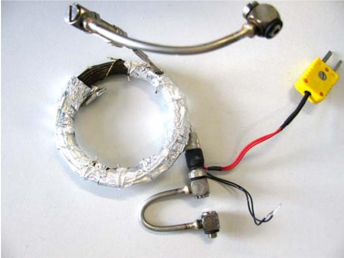
**Abb. 29:** GC mit 4 parallel aufgewickelten Säulen
