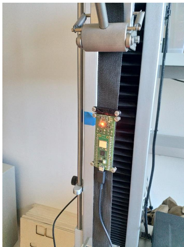
Abbildung 18 - Beispiel für Befestigung des Sensor an einem Gurtband. Hier eingespannt in einer Universalprüfmaschine
