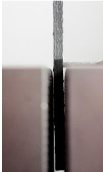
Abbildung 5: gekrümmte Probe innerhalb der Spannbacken
