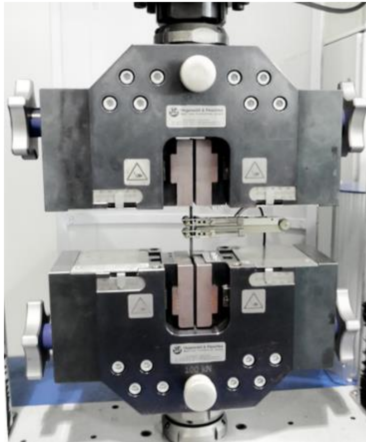
Abbildung 3: Setup für Zugversuche
