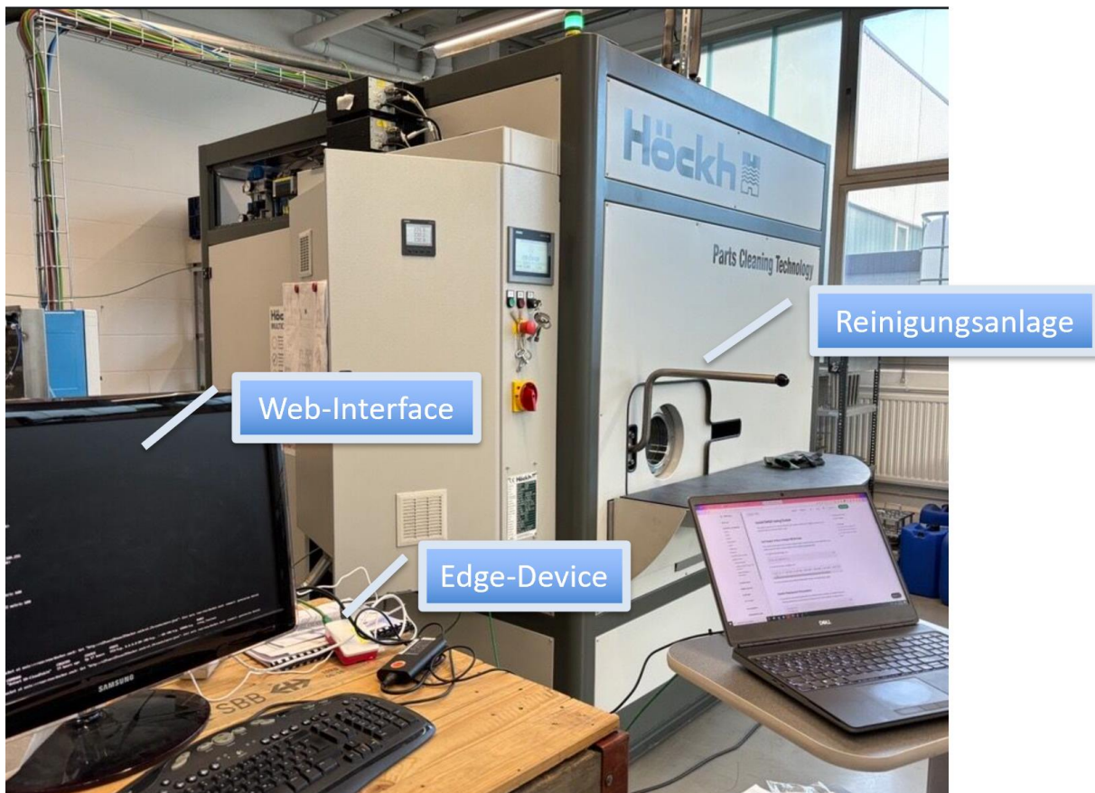
Abb. 9: Aufbau der Kommunikation zum Sammeln der Daten bei Höckh
