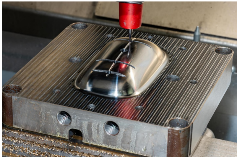
Abbildung 30: Fertigung der Rippenstruktur des auswerferseitigen Formeinsatzes auf HSC Fräsmaschine
