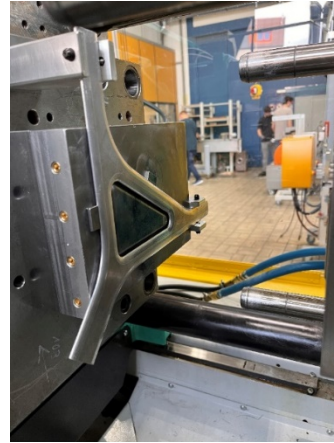
Abbildung 1: CAD 3d-Abbildung Demonstratorwerkzeug (li) und Demonstratorwerkzeug in Spritzmaschine eingebaut (Bild Uni Kassel, re)
