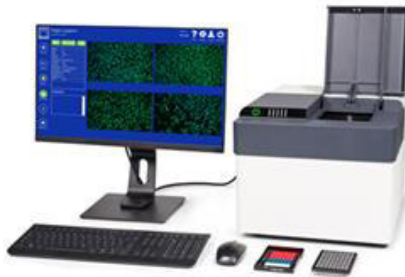
Abbildung 5. Prototyp des erweiterten Fluoreszenzmikroskops zur Detektion im VIS und im NIR
