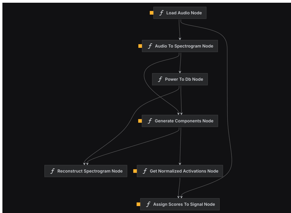
Abbildung II.2: Kedro-Pipeline für automatische Datenkennzeichnung im Anwendungsfall Bremsgeräusche.
