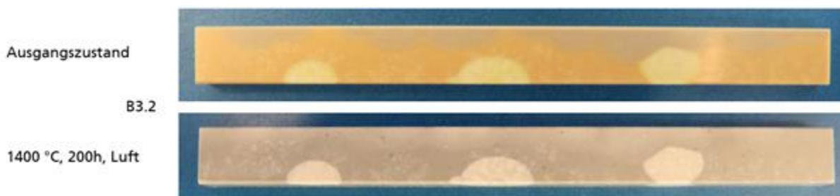
Bild 3-11: Biegestab von Material B3.2 vor und nach dem Oxidationstest; die gelben Bereiche (rund) zeigen eine weißliche Verfärbung, welche auf stärkere Oxidation (in Verbindung mit Porenbildung) hindeutet
