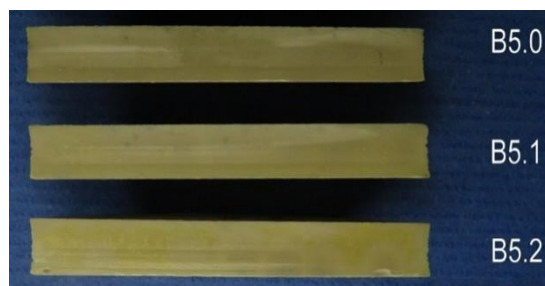
Bild 3-8: Ein höherer \text{SiO}_2 -Gehalt führt zu homogenerer Farbgebung der Querschnitte heißgepresster Platten
